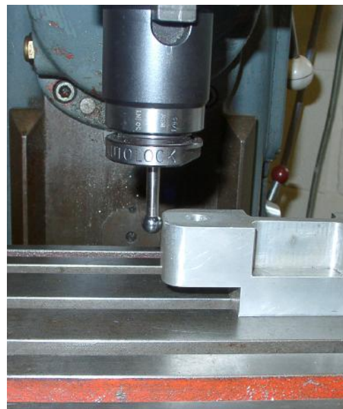
図7.12--工場で使用中の縁ファインダー
