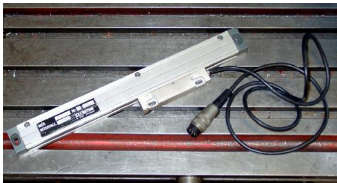
図4.15--ガラススケールエンコーダ(インストールを待ちます)
