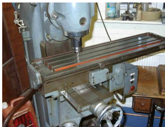
図4.10-- X=0のツール、Y=0位置と共にかかげぐってください(リミット・スイッチの上に犬がいることに注意してください)。
